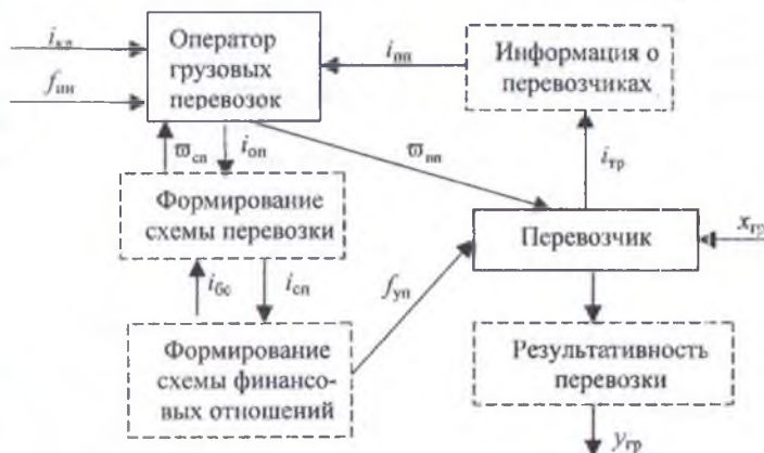
Рисунок 1.11 – Функциональная схема организации перевозочного процесса в грузовом движении
